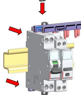
2. Tirer l'appareil vers l'avant afin de le dégager du rail
